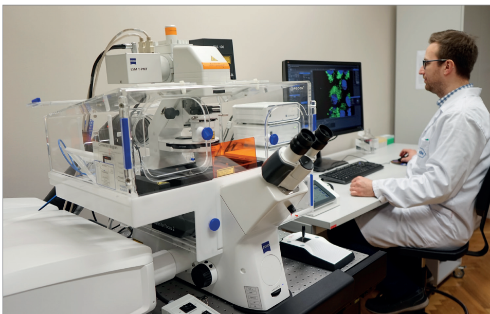
79. Mikroskop konfokalny najnowszej generacji do obrazowania 3D Katedry Genetyki i Podstaw Hodowli Zwierząt (Zeiss LSM 880 Airyscan Fast; 2018)
