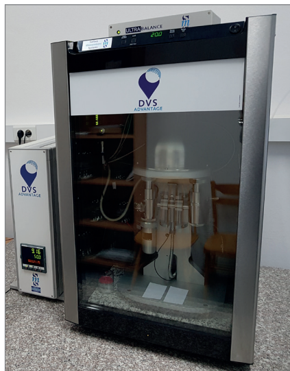
78. Nowej generacji system do pomiaru sorpcji i dyfuzji wody w drewnie i materiałach drewnopodobnych Katedry Mechaniki i Techniki Ciepłej (Surface Management Systems Ltd, London, UK)
