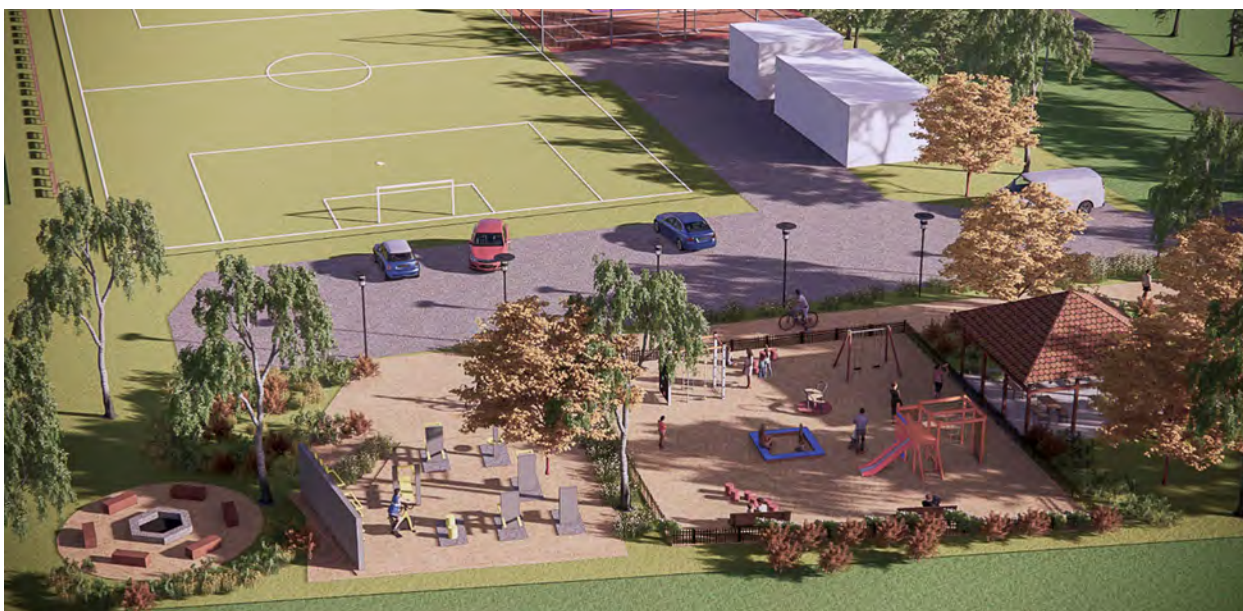
Kotuń 2, stan projektowany: teren podzielono na cztery strefy funkcjonalne. Od północy ulokowano ognisko, oddzielając je od istniejącej siłowni zewnętrzną przegrodą. Ma ona stwarzać wrażenie odosobnionego wnętrza, zarówno dla przestrzeni przyogniskowej, jak i sportowo-rekreacyjnej. Obok siłowni zlokalizowano plac zabaw dla dzieci, z niewielką strefą podziału pomiędzy siłownią a wspomnianym placem. Ten pas zieleni daje możliwość wglądu na płaszczyznę strefy dziecięcej, dzięki czemu rodzice, ćwicząc na siłowni, mają na oku bawiące się pociechy. W bezpośrednim sąsiedztwie dziecięcej strefy ustawiono wiatę wraz ze stołami. Zapewnienie ochrony przed deszczem, słońcem lub odpoczynku jest priorytetowe, bowiem obecnie teren ten jest latem bardzo nasłoneczniony. Strefę sąsiadującą bezpośrednio z pasem drogowym pozostawiono do dyspozycji mieszkańców pobliskich budynków. Można tam zorganizować utwardzony plac przed wiatą, strefę zieleni/kwiatów lub po utwardzeniu tego fragmentu wygospodarować miejsce na „małą gastronomię” (np. food truck podczas lokalnych zawodów sportowych czy imprez wiejskich).
