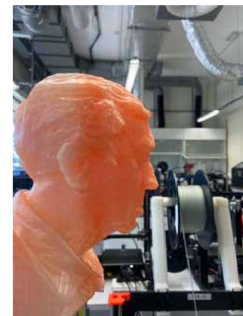
Wydruk 3D głowy prof. Bogdana Marcińca, twórcy i pierwszego dyrektora CZT. Wydruk powstał z biomateriału na podstawie laserowego skanu.
